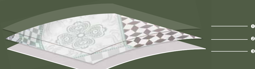
① Vernis spécial anti-taches ② Feuille PVC imprimée ③ Support tissé
